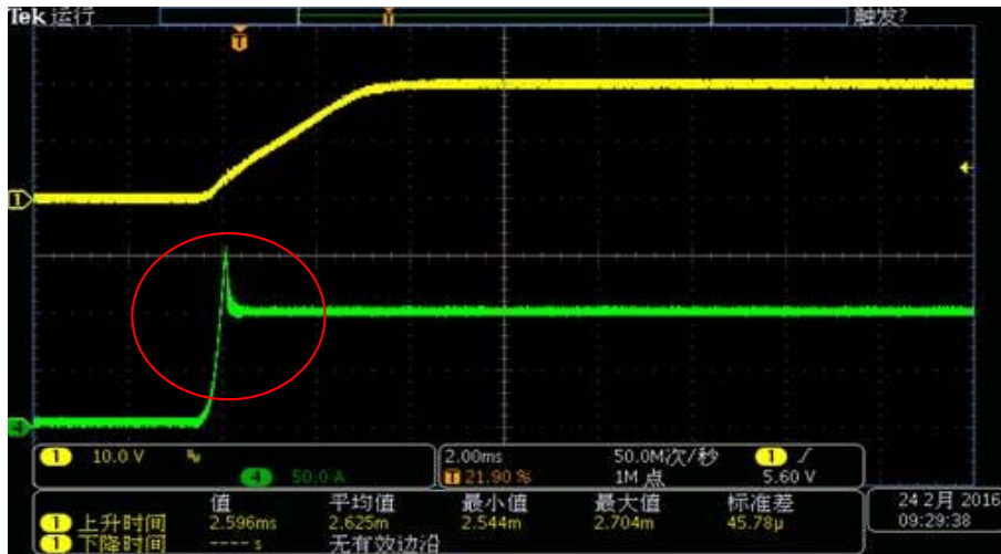
图二 CV 优先工作下，电流（绿色）电压（黄色）输出波形
